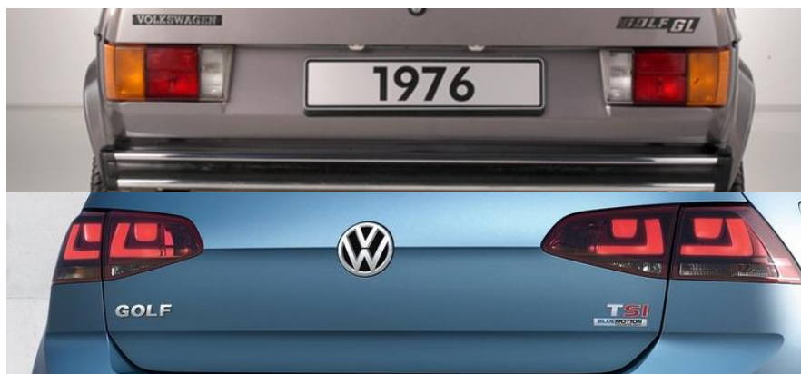
Abbildung 1: Designentwicklung am Beispiel der VW Golf Heckleuchte (Glühlampenversion). Oben Heckleuchte von 1976, unten: Heckleuchte von 2012.
