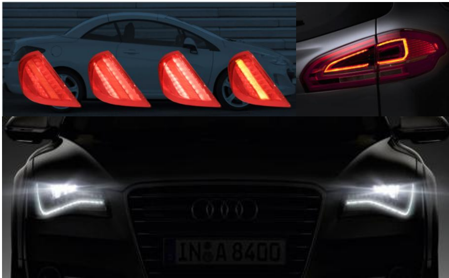
Abbildung 2: Beispiele für Stylinginnovationen bei Signalleuchten und Scheinwerfern mit LED-Technik. Links: Peugeot 308 CC mit Lichtvorhang, rechts: Ford S-Max mit Edge Light, unten Audi A8 mit Voll-LED AFS Scheinwerfer.
