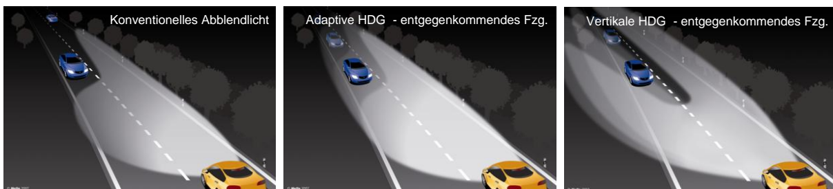
Abbildung 4: Prinzipdarstellung der adaptiven- und vertikalen HDG im Vergleich zu konventionellem Abblendlicht.
