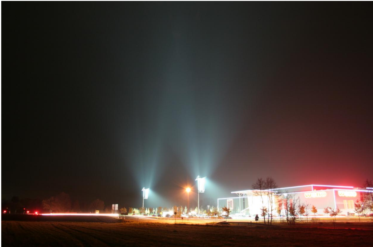
Abbildung 2: Einkaufszentrum in Rosenheim. Eine derartige Beleuchtung mit Lampen, die sekundäre Reflektoren aufweisen, ist in Slowenien nicht erlaubt, da es damit nicht möglich ist, Null-Lichtemissionen über dem Horizont zu erzielen.
